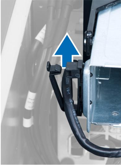
7. 提起 ODD 固定框架顶部的释放门锁。
