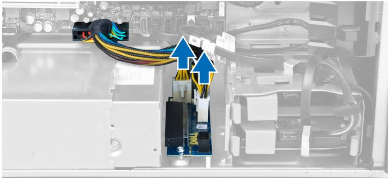
6. 拧下用于将 PSU 卡固定至插槽的螺钉。
