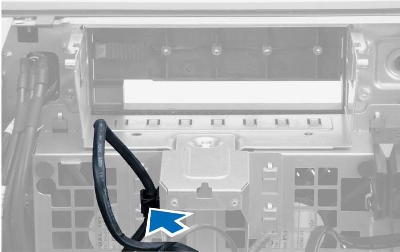
4. 拧下将金属板固定至系统风扇的螺钉。
