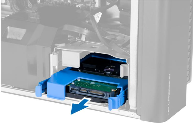
6. 如果已安装 2.5 硬盘驱动器，拧下螺钉并提起硬盘驱动器，将其从硬盘驱动器盒中卸下。
